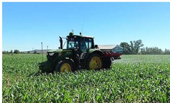
Figura 16. Tractor realizando abonado de aplicación variable.
