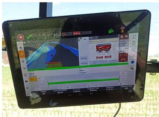
Figura 15. Monitor del tractor visualizando el abonado que se está aplicando en ese momento.
