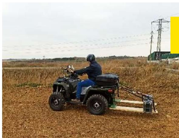
*Figura 6. Sensor Geonic EM38 arrastrado por un quad.*
