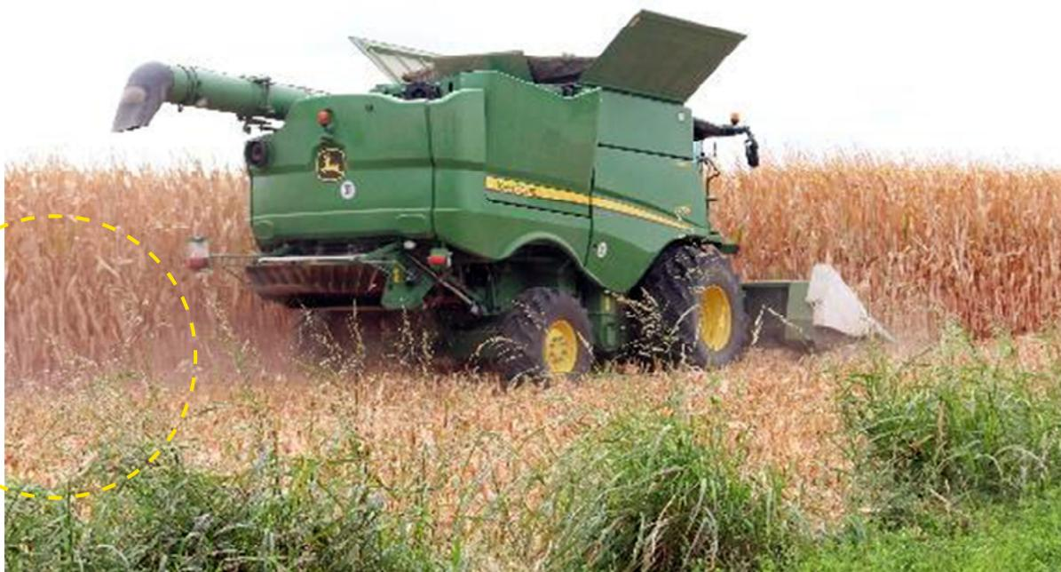
*Figura 20. Cosechadora con monitor de rendimiento.*
